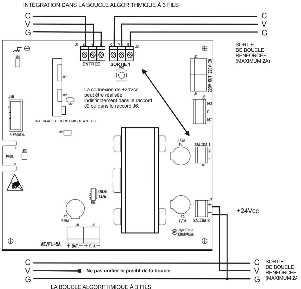
Le courant de sortie dans la boucle algorithmique ne doit pas dépasser **2 ampères** afin d'éviter des problèmes dans les communications causées par les chutes de tension dans le câblage.
