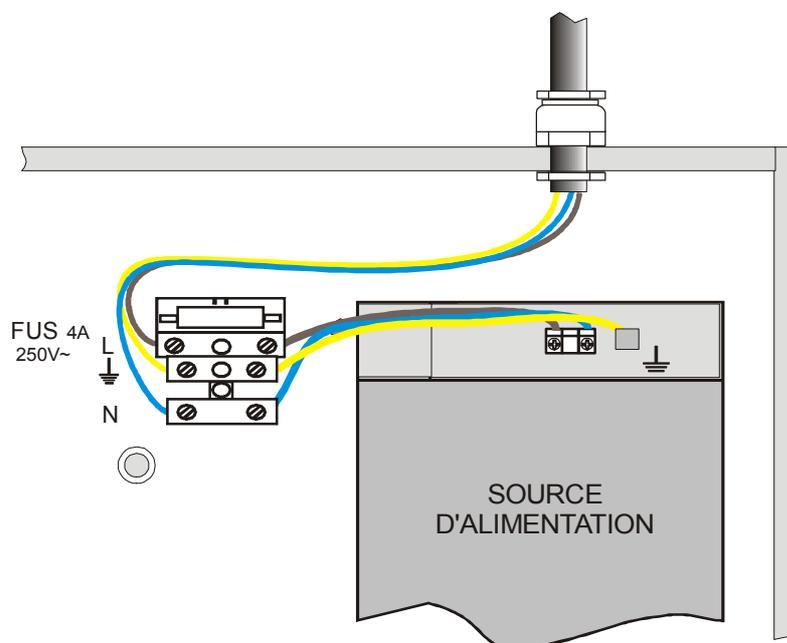
L'alimentation des équipements de contrôle d'incendies doit disposer d'un différentiel de protection indépendant avec un fusible de protection de 230 Vca / 4 A ou supérieur. La section de câblage d'alimentation ne doit pas être inférieure à 0,75 mm<sup>2</sup>.
