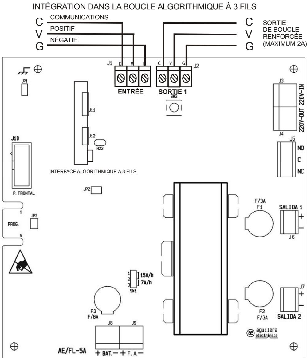
Pour un fonctionnement correct, il est nécessaire que le module interface analogique soit situé dans les connecteurs J11 et J12.
