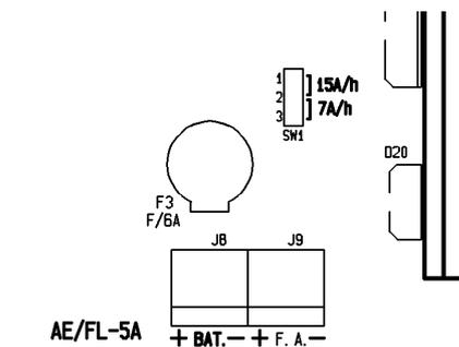
Le limiteur de courant du circuit de contrôle du chargeur de batteries doit être sélectionné en fonction des batteries qui ont été connectées à la source d'alimentation. Le courant maximal est limité à 0,05C.
