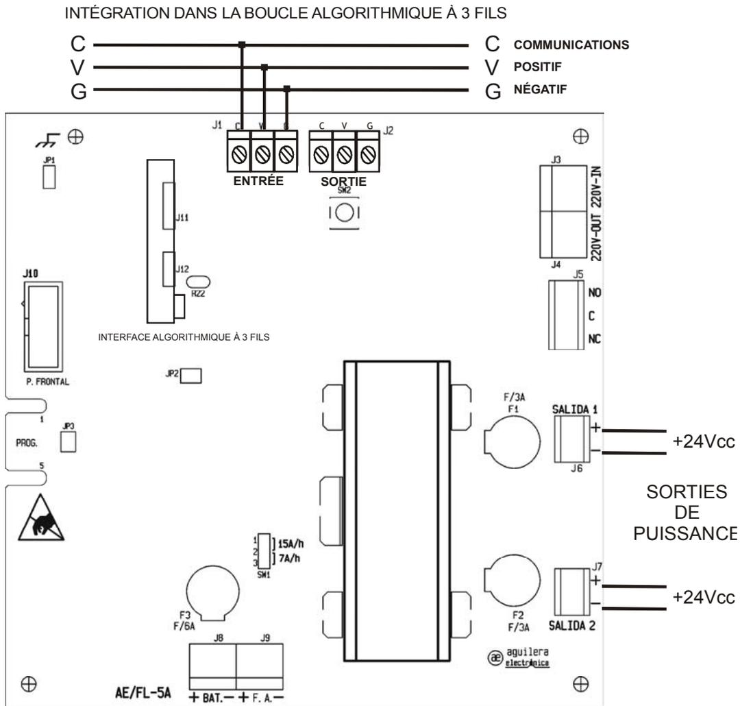
Pour un fonctionnement correct, il est nécessaire que le module interface algorithmique à 3 fils soit situé dans les connecteurs J11 et J12.
