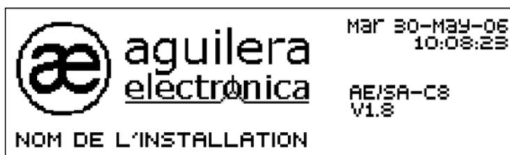
La partie de droite affiche la date et l'heure de la centrale et, un peu plus bas, le modèle de la centrale et la version du logiciel.
