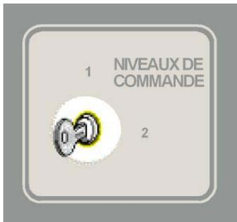
La centrale se trouve à tout moment dans un niveau d'accès déterminé. Lorsque la centrale initialise le système au démarrage, elle fixe comme niveau d'accès actuel celui indiqué par la clé de la partie frontale, à savoir 1 ou 2.
