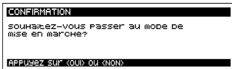
**i** Lorsque la centrale se trouve dans le mode Mise en marche, l'installation de détection d'incendies n'est pas opérationnelle. Ce mode ne doit être utilisé que pour la mise en marche de l'installation et pour des tâches de maintenance.
