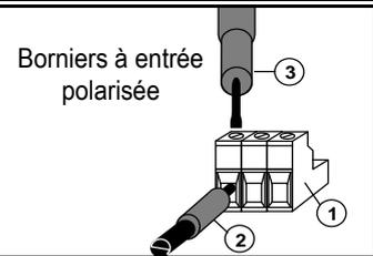
Il est impératif de mettre hors tension les appareils électroniques lors d'installation, et de toutes opérations de modification des connexions et/ou de connexion ou déconnexion de cartes d'extensions.
