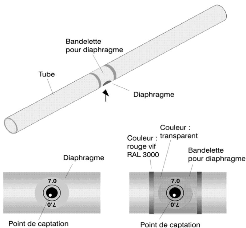
Figure 17: Point de captation avec diaphragme et bandelette
