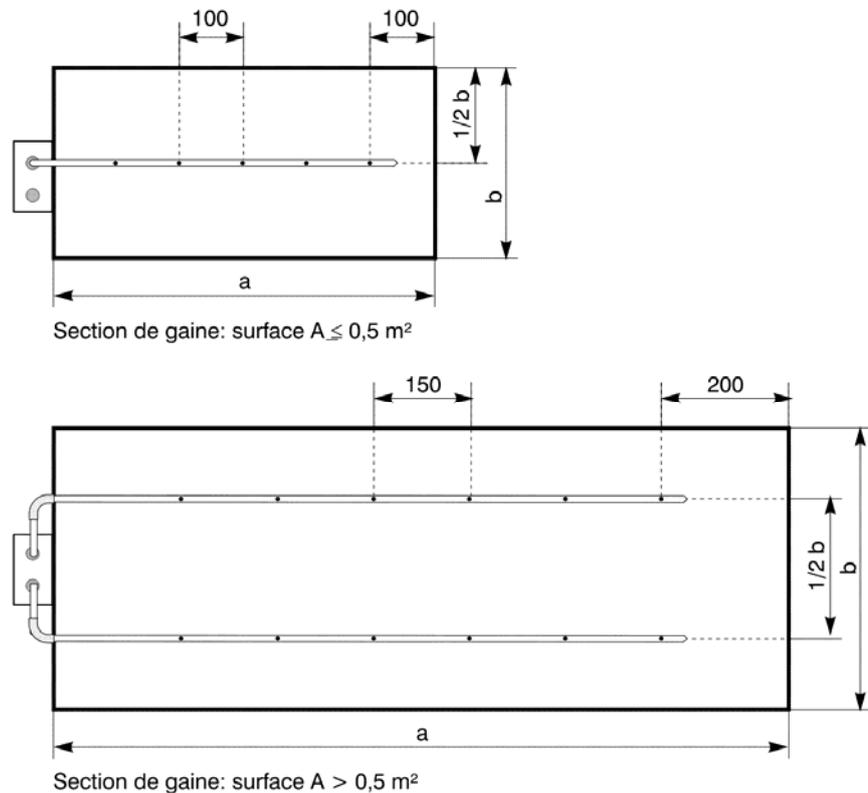
Figure 61: Gains avec petite et grande section
