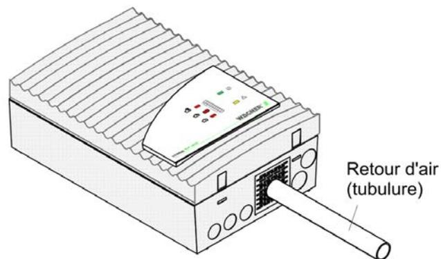
Figure 96: Installation de la tubulure de retour d'air
