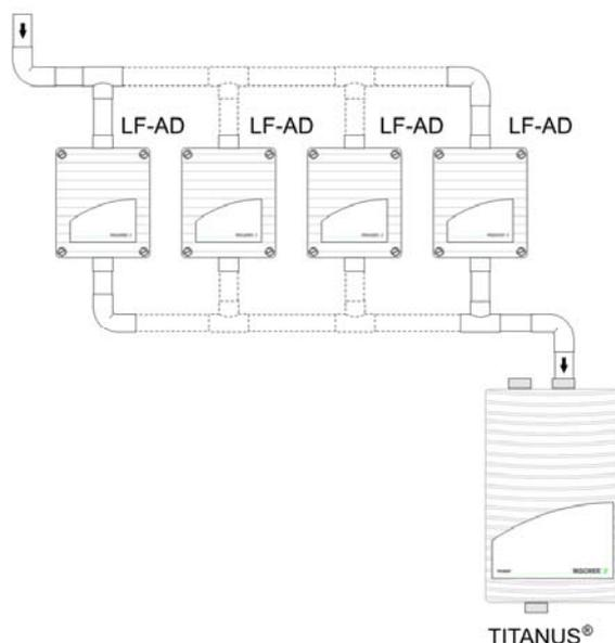
Figure 24: Filtres LF-AD dans l'embranchement d'aspiration principal
