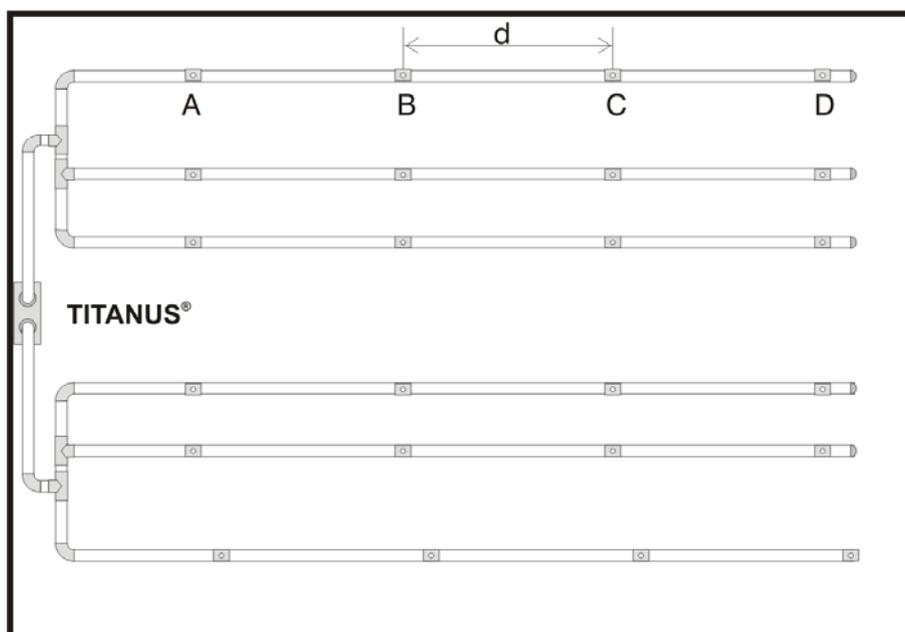
Figure 41: Tubulure en M pour la protection volumétrique
