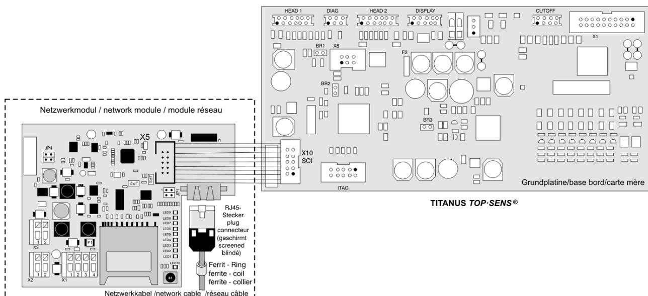
Figure 77: Raccordement de la carte réseau
