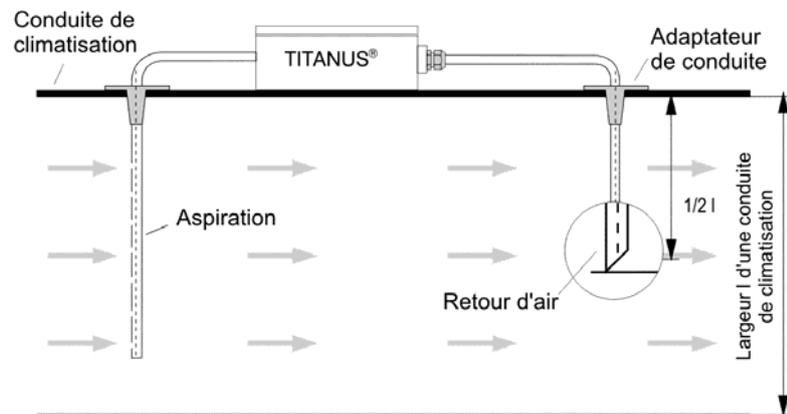
Figure 92: Positionnement du retour d'air, exemple de conduite climatisée (by-pass)
