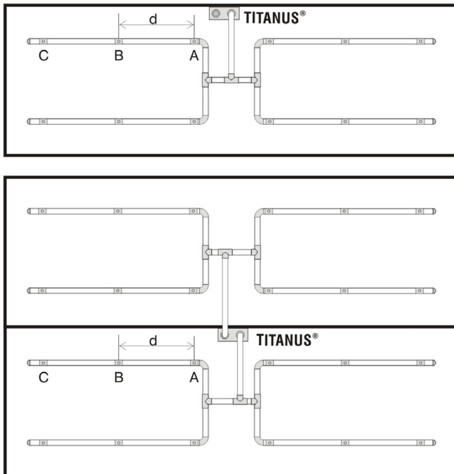
Figure 42: Tubulure en double U pour la protection volumétrique
