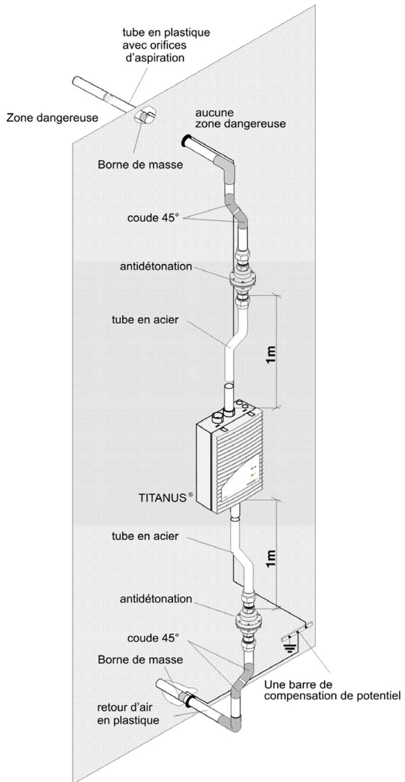
Figure 101: Montage de l'antidétonation avec mise à la terre
