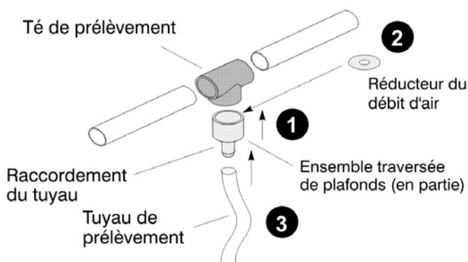
Figure 90: Montage de tuyau capillaire et de l'écran en amont
