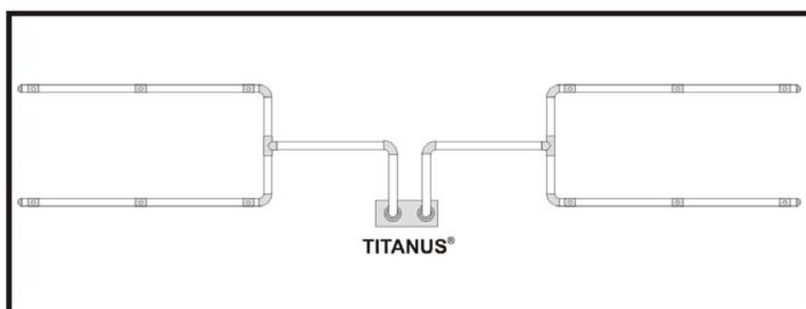
Figure 44: Tubulure en U, p. ex. pour la protection d'équipement
