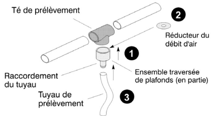
Figure 20: Montage de tuyau capillaire et de l'écran en amont
