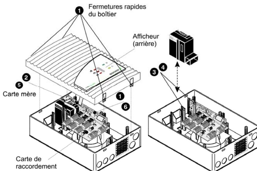
Figure 109: Remplacement du module de détection
