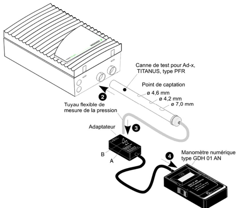
Figure 106: Vérification de fonctionnement du TITANUS TOP·SENS®
