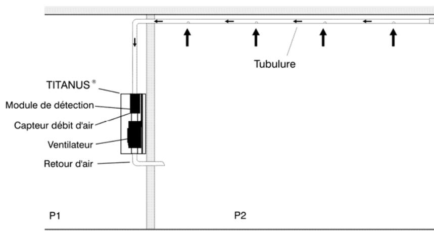
Figure 25: Schéma de principe du retour d'air de TITANUS®
