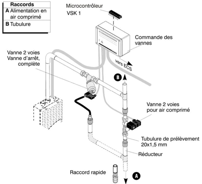
Figure 16: Composants pour système de dé colmatage automatique
