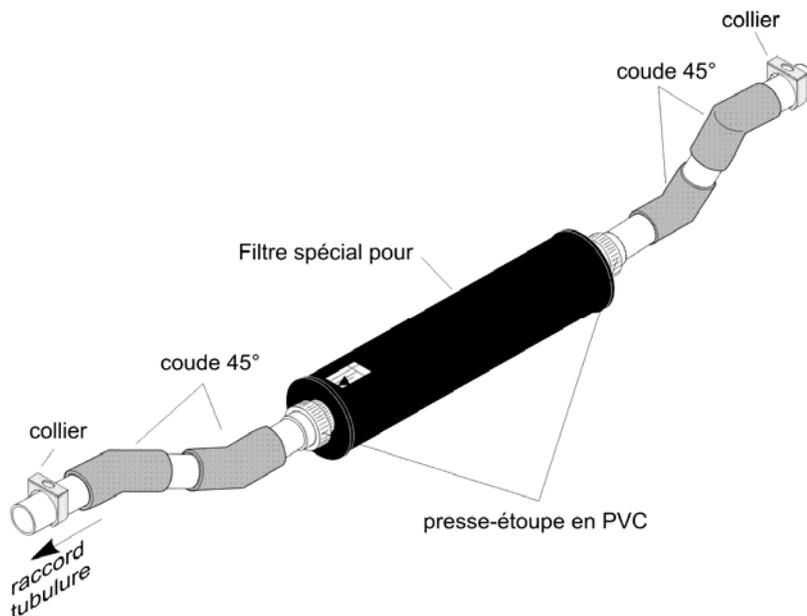
Figure 94: Montage du filtre spécial dans la tubulure
