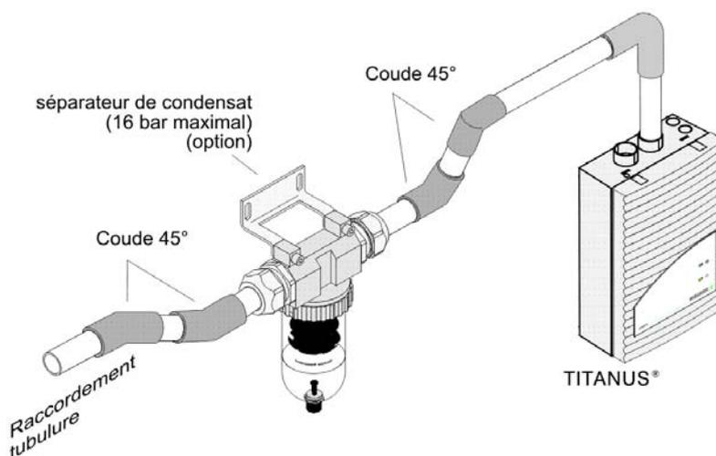
Figure 99: Montage du séparateur de condensat Type KA-DN-25 dans la tubulure
