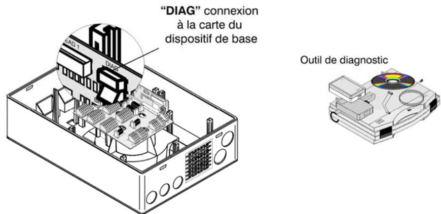
Figure 10: Logiciel de diagnostic pour lire l'état du dispositif
