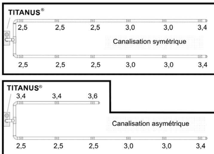
Figure 31: Exemple de tubulure en U symétrique et asymétrique
