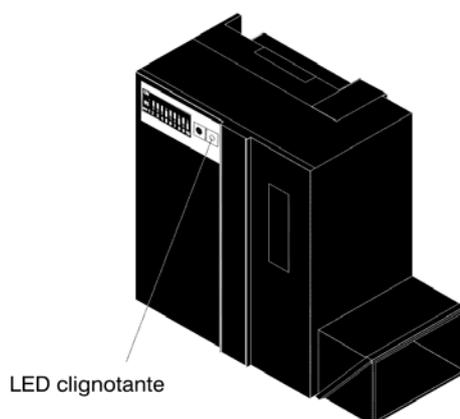
Figure 107: Position de la LED à code clignotant sur le module de détection
