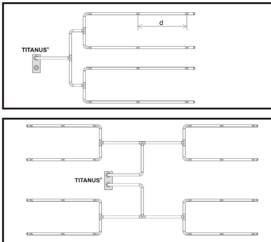
Figure 46: Tubulure en double U, p. ex. pour la protection d'équipement
