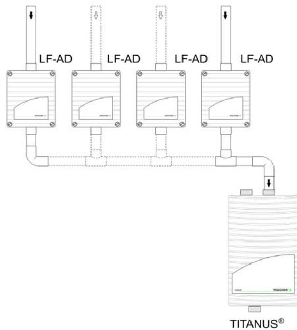
Figure 23: Filtres LF-AD dans plusieurs embranchements d'aspiration
