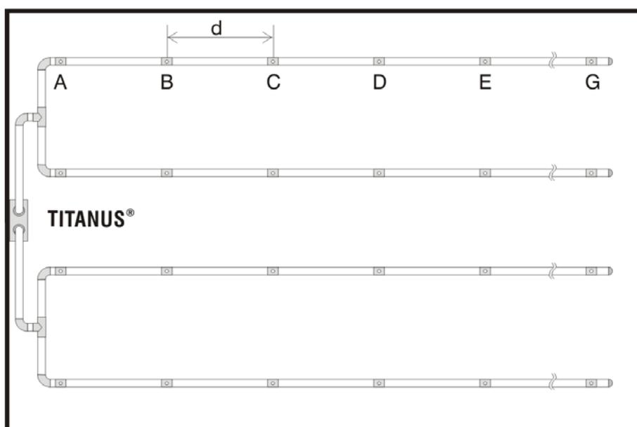
Figure 40: Tubulure en U pour la protection volumétrique
