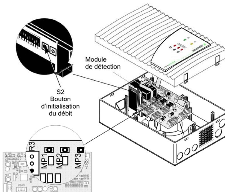
Figure 104: Réglage indépendant de la pression dans le TITANUS TOP-SENS®
