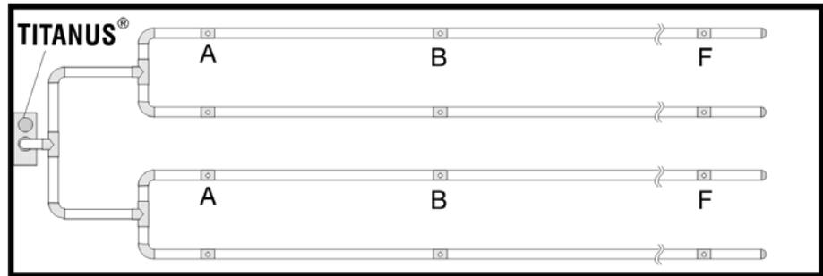
Figure 37: Tubulure en double U
