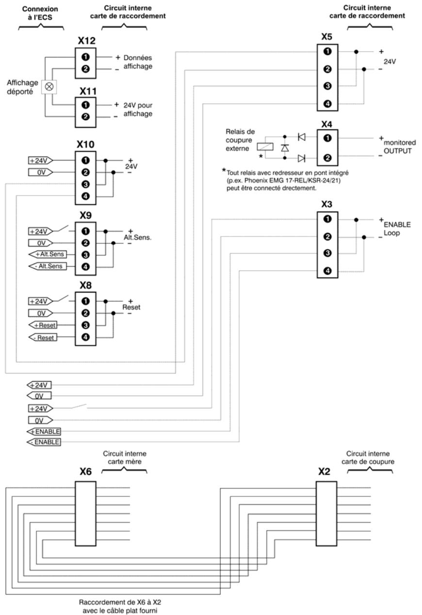
Figure 75: Raccordement du module de coupure
