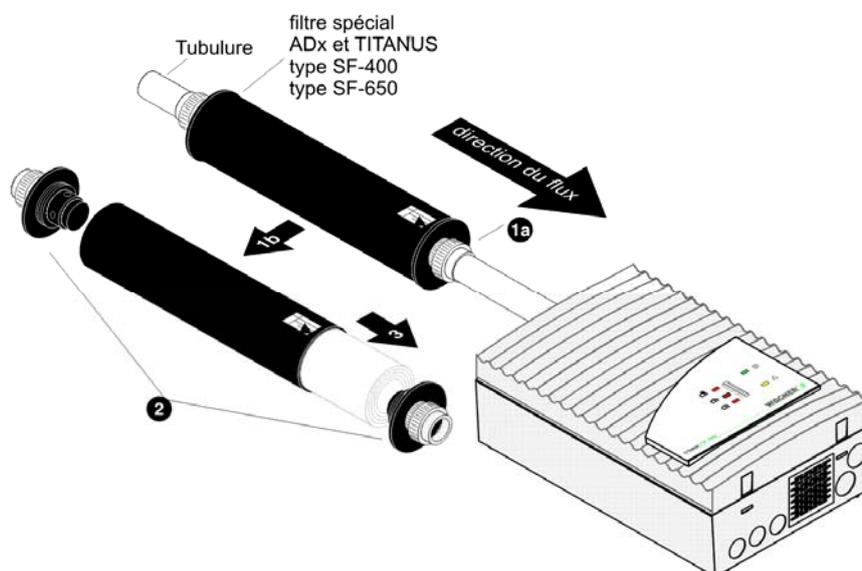
Figure 111: Remplacement du filtre
