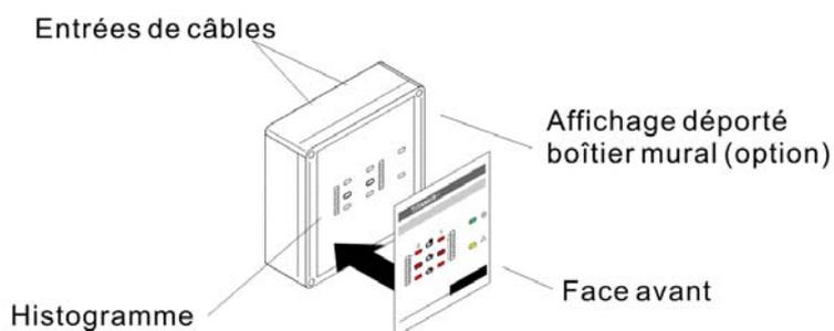
Figure 81: Montage de la face avant de l'affichage déporté
