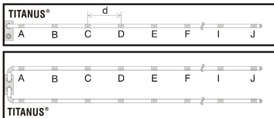
Figure 39: Tubulure en I pour la protection volumétrique
