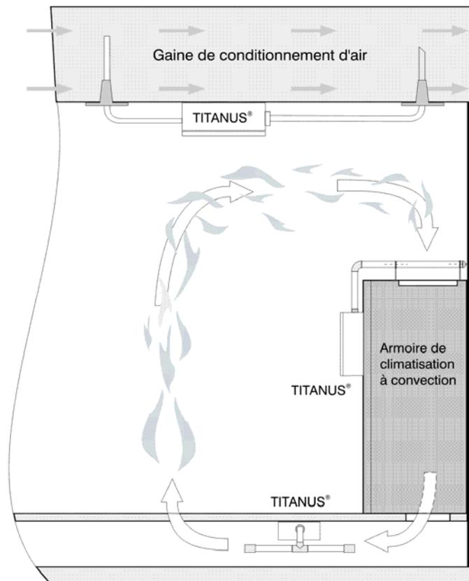
*Figure 2: Possibilités de surveillance d'une armoire de climatisation à convection ou gaine de conditionnement d'air*
