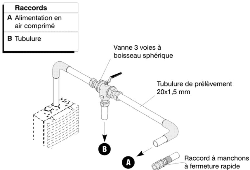
Figure 15: Composants pour système de décolmatage manuel
