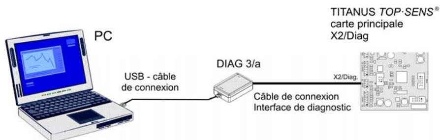
Figure 85: Connexion d'un PC par le câble de connexion de l'interface de diagnostic
