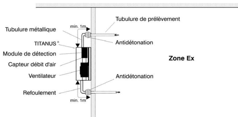
Figure 30: Antidétonation dans la tubulure de prélèvement et, si besoin, dans le retour d'air
