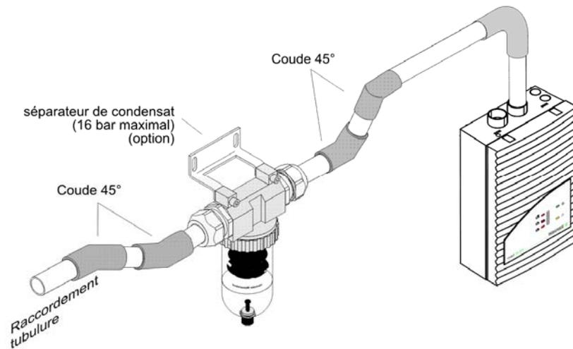
Figure 28: Séparateur de condensat pour condenser la vapeur d'eau et récupérer l'eau de condensation de la tubulure
