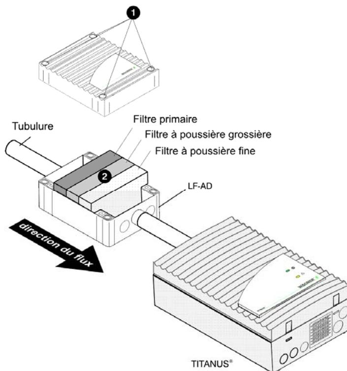
Figure 110: Remplacement des filtres
