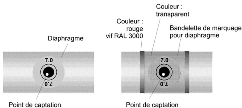
Figure 87: Exemple d'un point de captation avec diaphragme
