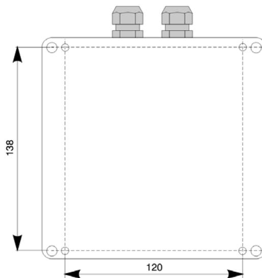
Figure 82: Distance entre les orifices de l'affichage déporté dans le boîtier
