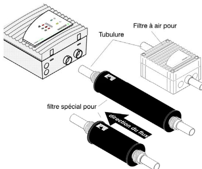
Figure 21: TITANUS TOP-SENS® avec filtre à air
