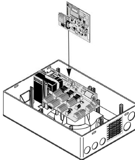
Figure 76: Installation de la carte réseau dans le TITANUS TOP·SENS®
