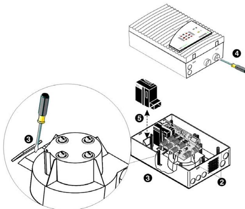
Figure 78: Installation du deuxième module de détection
