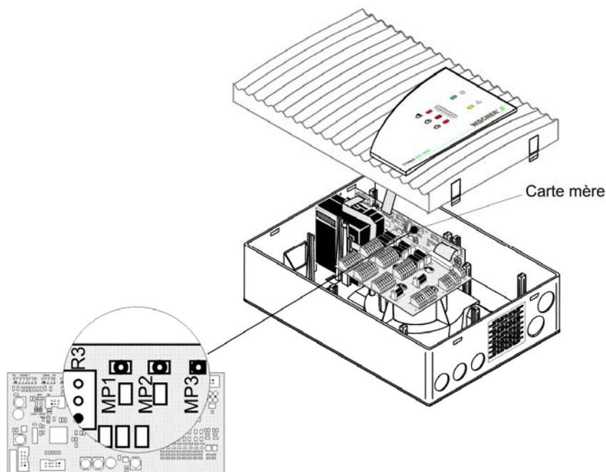
Figure 105: Réglage du débit d'air dépendant de la pression atmosphérique du TITANUS TOP•SENS®
