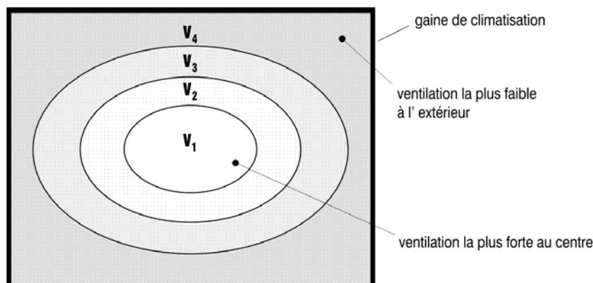
Figure 56: Répartition de la vitesse dans un canal de climatisation
