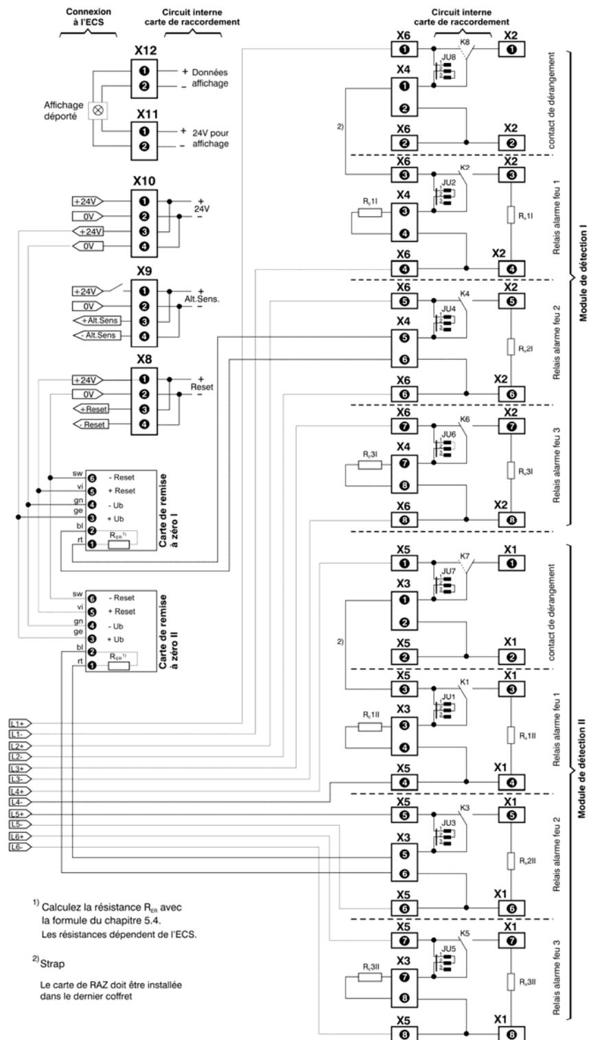
Figure 73: Exemple de raccordement du TITANUS TOP-SENS® à l'ECS avec carte de RAZ
