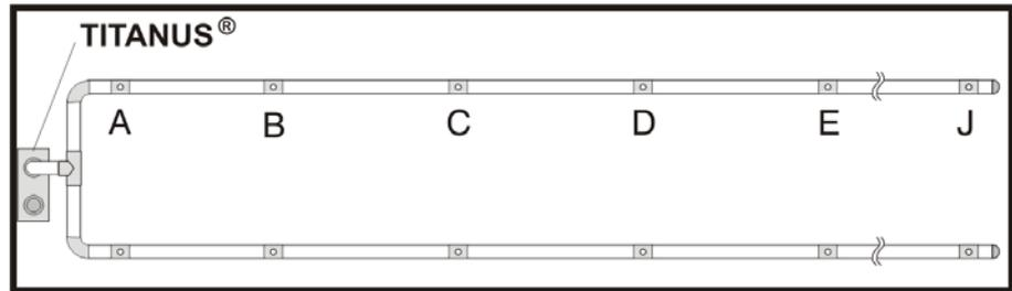
Figure 35: Tubulure en U
