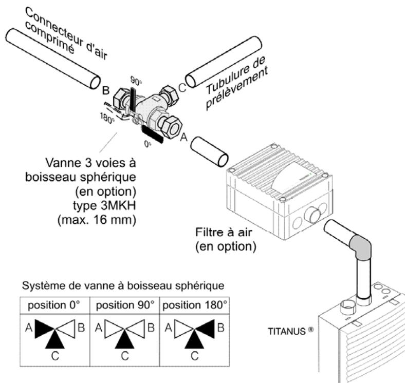
Figure 98: Montage du robinet sphérique 3 voies
