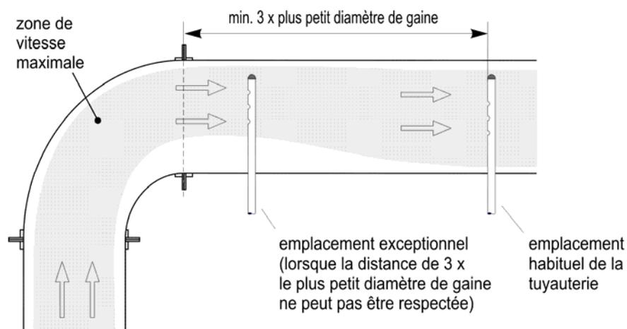
Figure 57: Changement de direction de la gaine sans plaque de guidage
