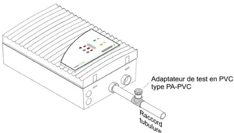
Figure 102: Montage de l'adaptateur de test sur la tubulure
