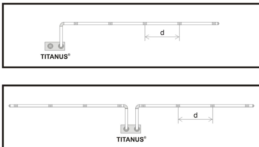
Figure 43: Tubulure en I, p. ex. pour la protection d'équipement
