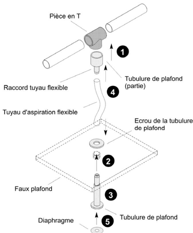
Figure 89: Installation de passage de faux plafond
