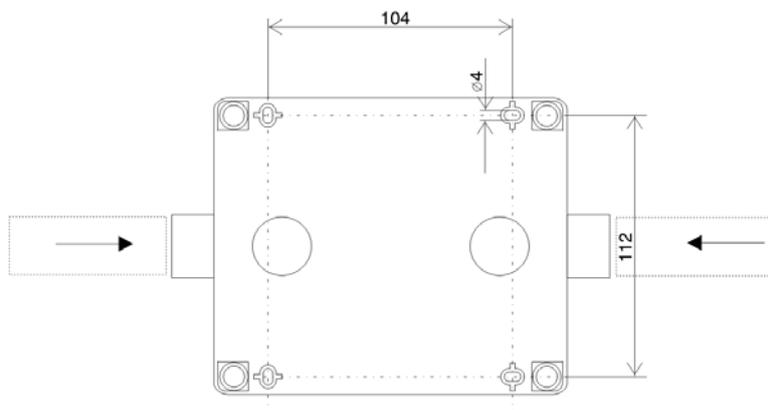
Figure 93: Espacement des orifices sur boîtier de filtre à air
