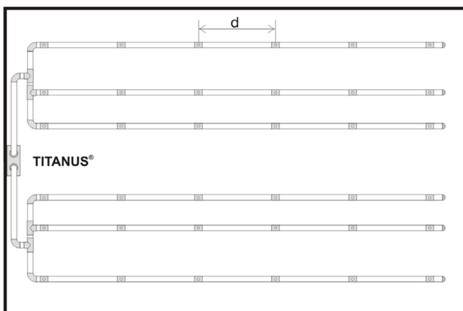
Figure 45: Tubulure en M pour la protection volumétrique
