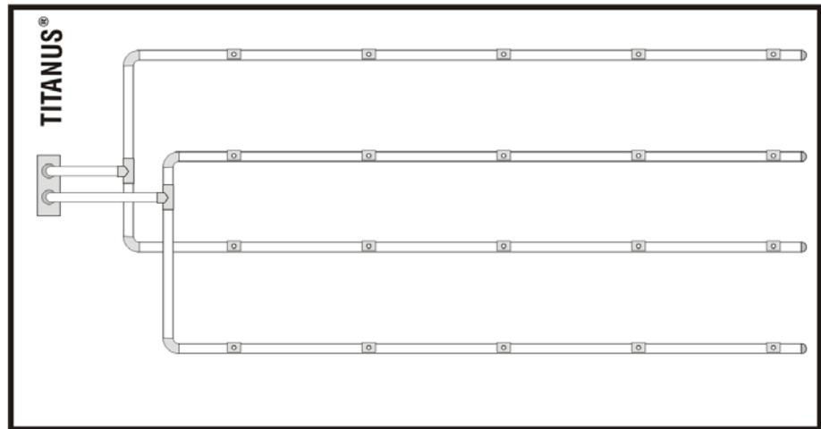
Figure 33: Configuration de tubulure pour double détection
