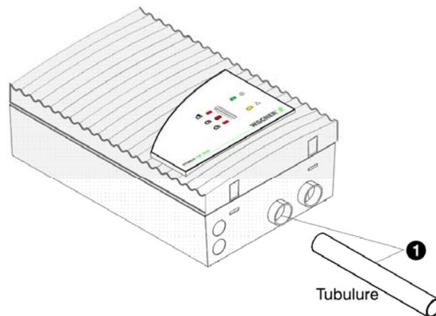
Figure 70: Connexion de la tubulure de prélèvement au TITANUS®
