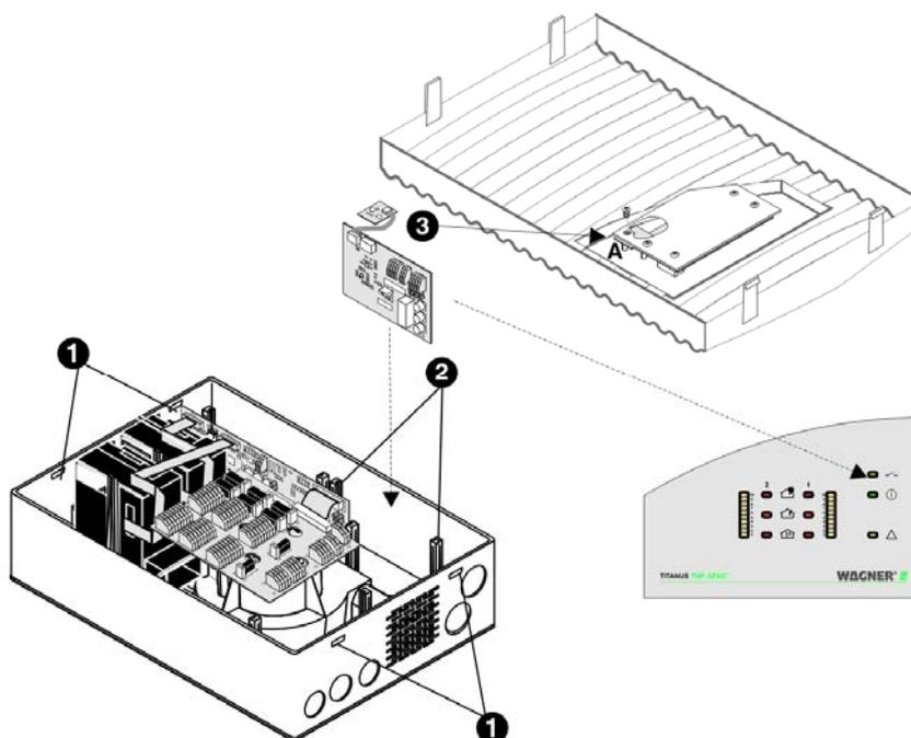
Figure 74: Installation du module de coupure dans le TITANUS TOP-SENS®
