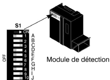
Figure 63: Réglages standard sur module de détection TITANUS TOP-SENS®
