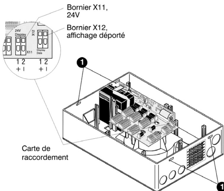
Figure 80: Raccordement de l'affichage déporté au TITANUS TOP-SENS®
