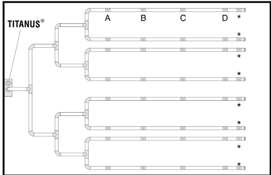
Figure 38: Tubulure en quadruple U
