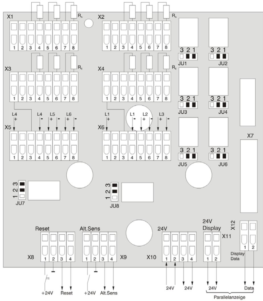
Figure 71: Emplacement des borniers sur la carte de raccordement
