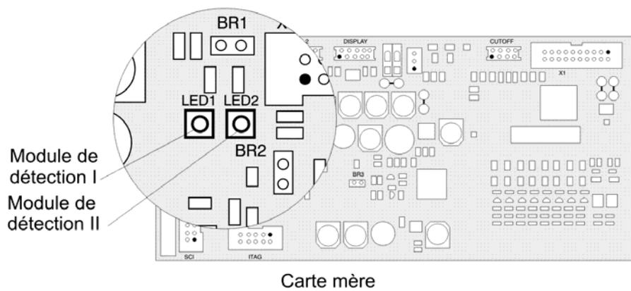
Figure 108: Position de la LED à code clignotant pour module de détection I et II sur carte mère
