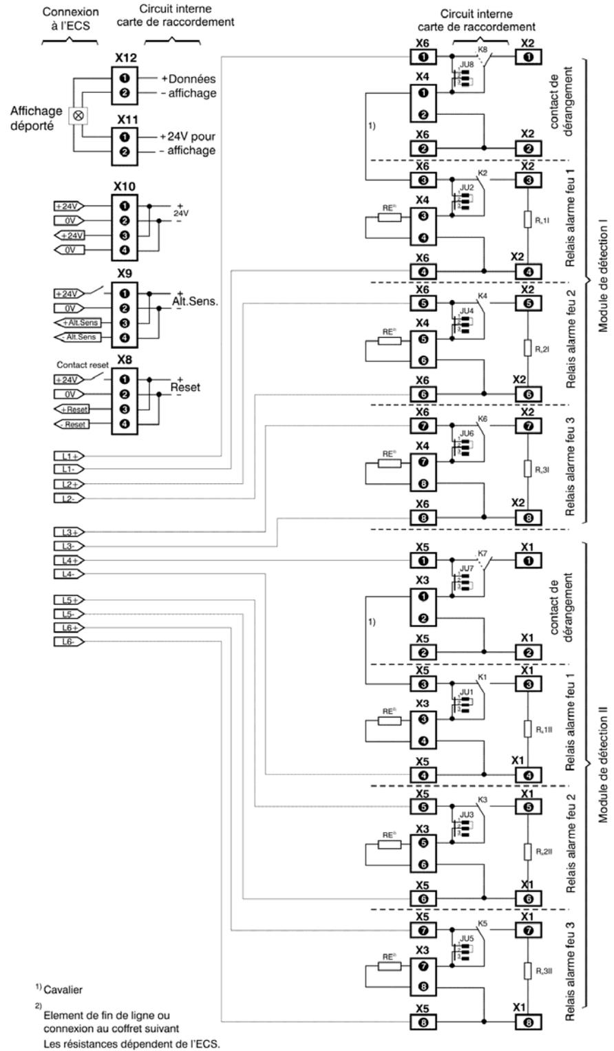
Figure 72: Exemple de raccordement du TITANUS TOP·SENS® à l'ECS avec bouton de RAZ
