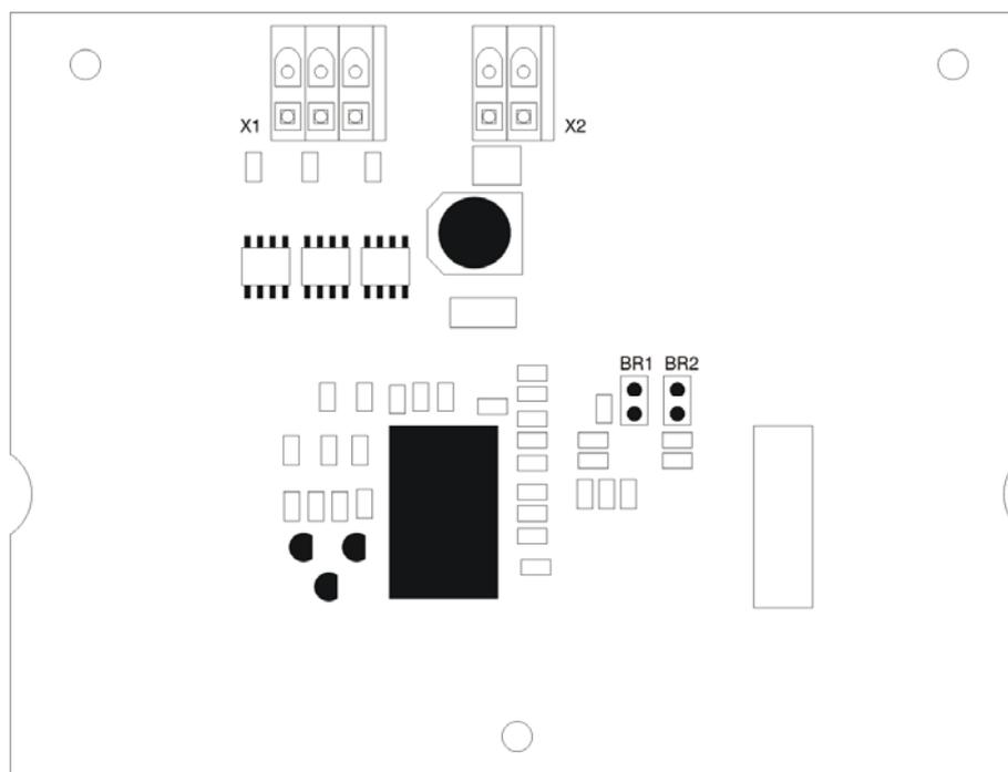
Figure 65: Réglage de la tension du ventilateur et bornier de raccordement du ventilateur sur la carte de commande du ventilateur FC-2 ou FC-3
