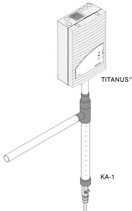
Figure 100: Montage du séparateur de condensat Type KA-1 dans la tubulure
