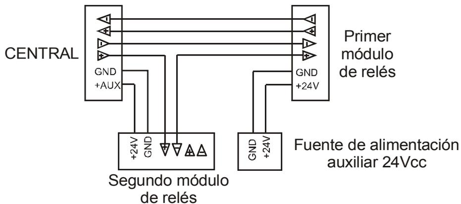
Figura 20. Conexión entre dos Módulos de Relés y la Central.
