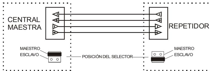
Figura 20. Conexión entre las Centrales Repetidor y Maestra.
