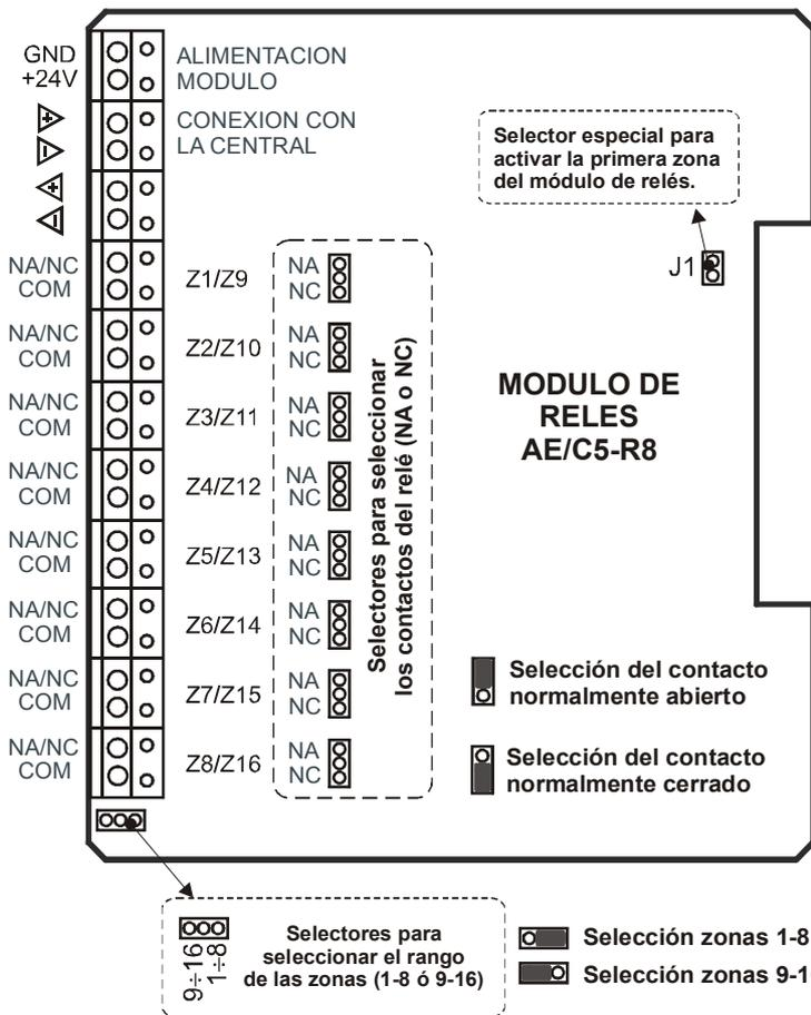
Figura 17. Configuración de terminales y puentes del AE/C5-R8.
