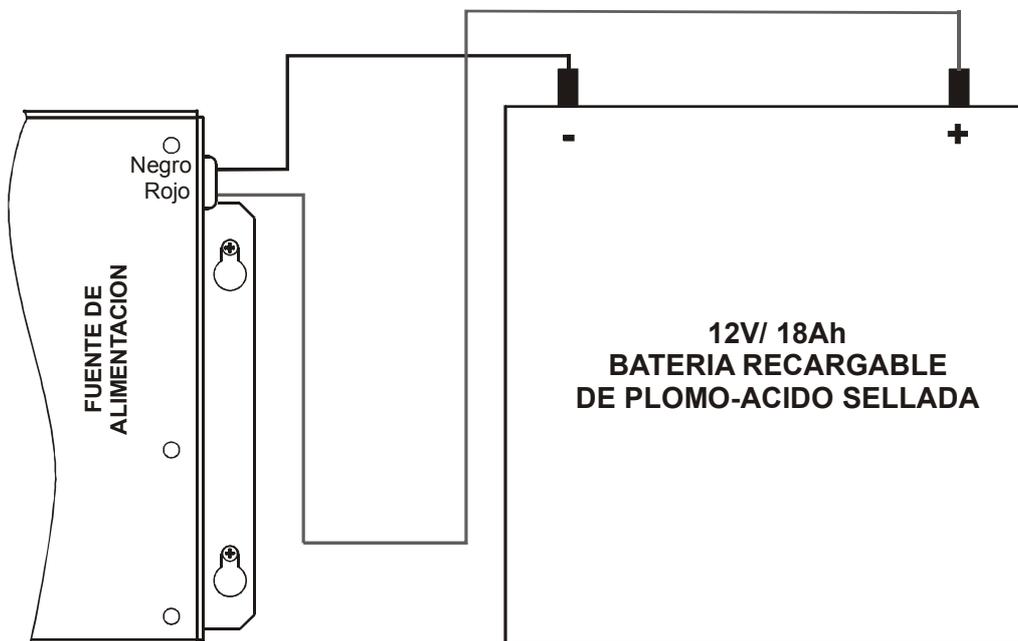
**Atención:** Es posible que la batería pueda no estar cargada en el momento de la puesta en marcha inicial de la Central. En este caso en el módulo de control se encenderá **BAT LOW/LOST (BATERÍA BAJA /AGOTADA)** y en el panel frontal **AVERIA GENERAL** hasta que la batería esté cargada al nivel requerido.
