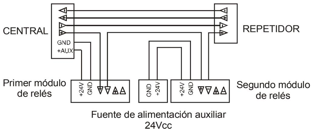
Figura 22. Conexión entre dos Módulos de Relés, Repetidor y el Central Maestra.
