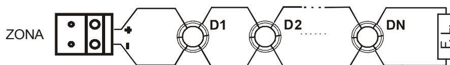
Figura 23. Conexión de detectores (D1÷N) a la tarjeta de zona.
