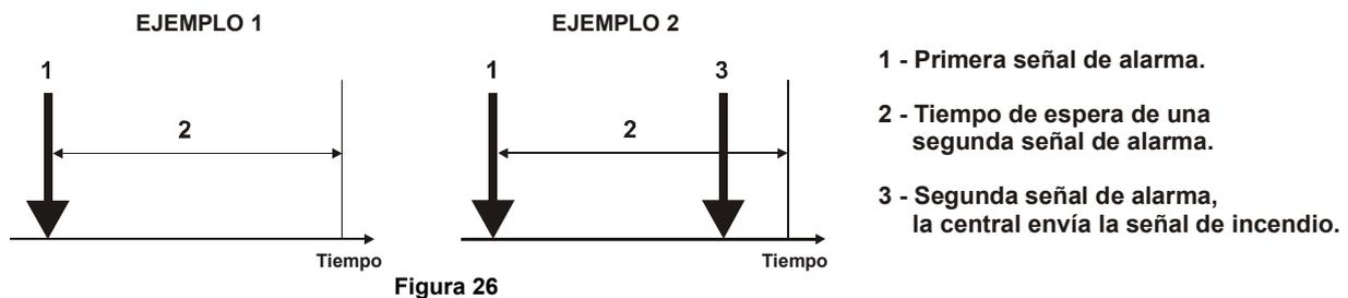
**EJEMPLO 1:** En este caso la Central de alarma de incendios no activará las sirenas ni la señalización en el panel frontal, debido a que durante el intervalo de tiempo 2 no se genera una segunda señal de alarma.
