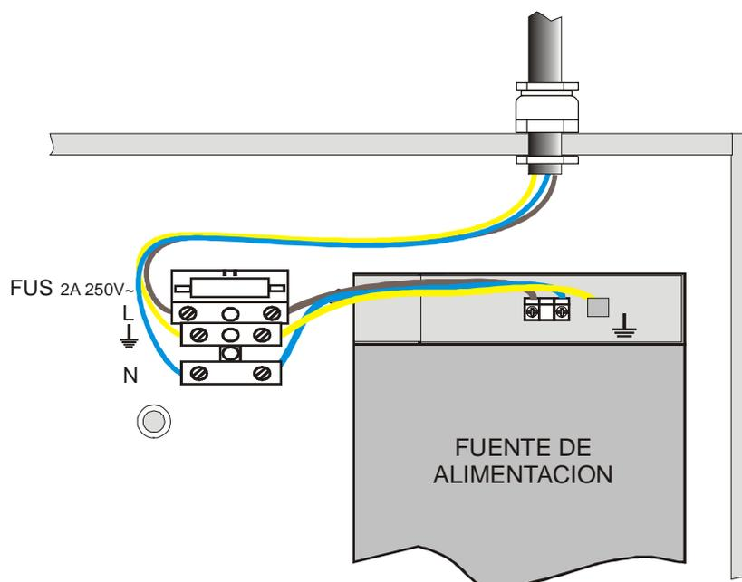
La alimentación de los equipos de control de incendios deberá disponer de un diferencial de protección independiente con un fusible de protección de 230Vca / 5A o superior. La sección de cableado de alimentación no será inferior a 0,75 mm<sup>2</sup>.
