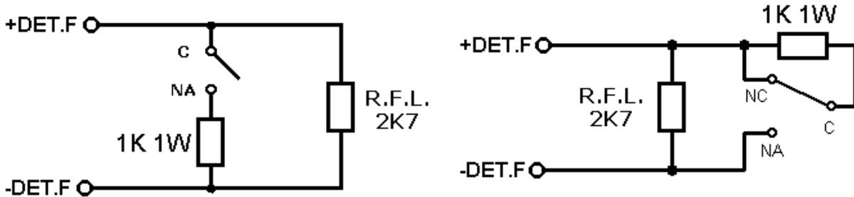
1. Conectar la resistencia de final de línea de 2K7 1/2W (rojo – morado - rojo), entre los terminales +DET.F y –DET.F. Esta resistencia viene conectada en las clemas de detector de flujo del panel de extinción PX2.
