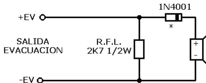
**NOTA:** El dispositivo de alarma, campana, sirena, etc. Debe estar provisto de un diodo interno que le proporcione polaridad a la alimentación. Si no lo lleva, es necesario colocar un diodo tipo 1N4001 o similar.
