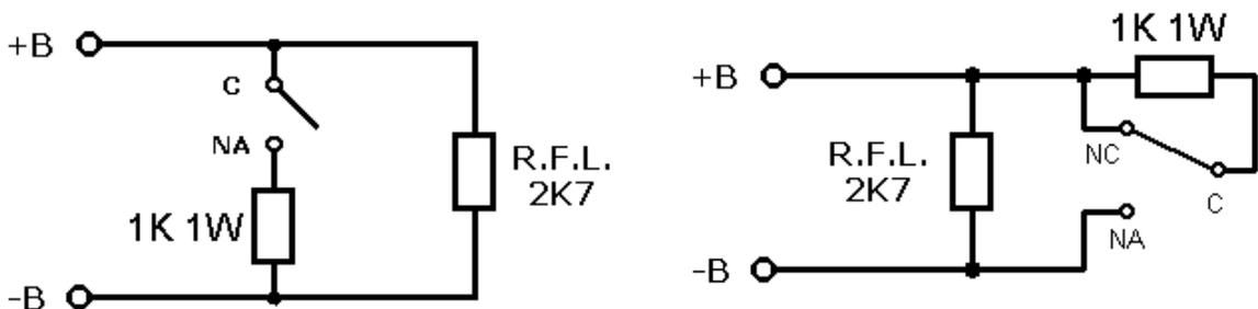
Utilizar cualquiera de las conexiones mostradas, en función de los contactos disponibles.
