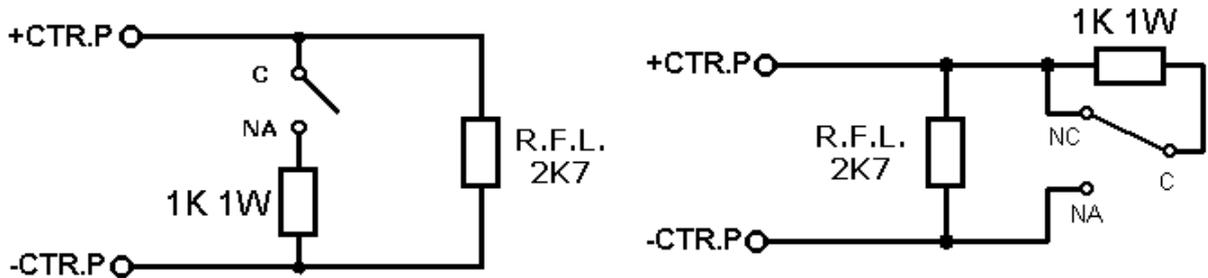
3. Conectar la resistencia de final de línea de 2K7 1/2W (rojo – morado - rojo), entre los terminales +CTR.P y –CTR.P. Esta resistencia viene conectada en las clemas del control de pesaje del panel de extinción PX2.
