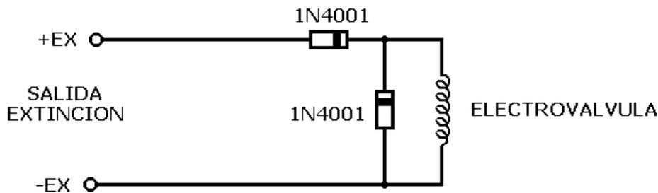
**NOTA:** Debe colocarse otro diodo en paralelo con la bobina de la electroválvula para evitar retornos de picos de corriente que puedan dañar el Panel de Extinción.
