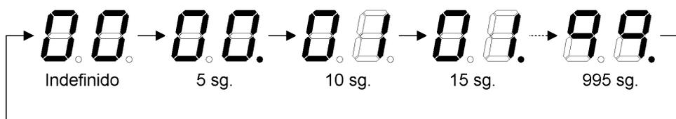
El tiempo “00” indica que la salida de extinción permanecerá activada por tiempo indefinido, hasta que se realice un rearme manual del Panel de extinción.
