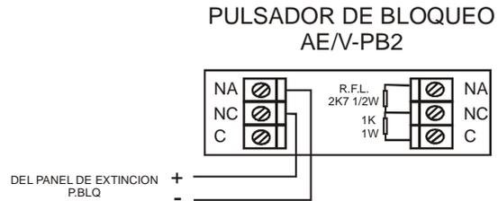
**NOTA:** Si se conectan varios pulsadores en paralelo conectar la resistencia final de línea únicamente en el último.
