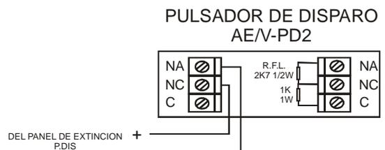
**NOTA:** Si se conectan varios pulsadores en paralelo conectar la resistencia final de línea únicamente en el último.
