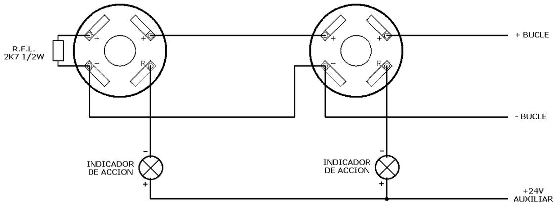
La conexión de sensores que proporcionan contactos libres de tensión es la siguiente:
