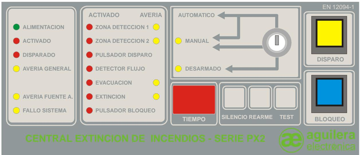
El modo de funcionamiento se establece según la posición de la llave, y es indicado mediante indicadores luminosos.
