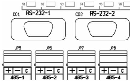
Los puertos COM1 y COM2 pueden configurarse como puertos RS-232 o RS-485, aunque obligatoriamente uno de ellos debe estar configurado como RS-232 a 9600 bps para permitir el volcado de la personalización. Normalmente este mismo puerto se utilizará simultáneamente para conectar una impresora, dejando el otro puerto libre para realizar integraciones de sistemas.
