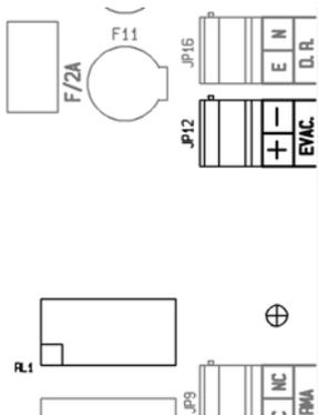
La conexión en la salida de Evacuación Local se realiza en la placa base en el conector JP12 mediante 2 hilos. Las diferentes sirenas o campanas de evacuación se conectan en paralelo y con una resistencia de final de línea de 2K7.
