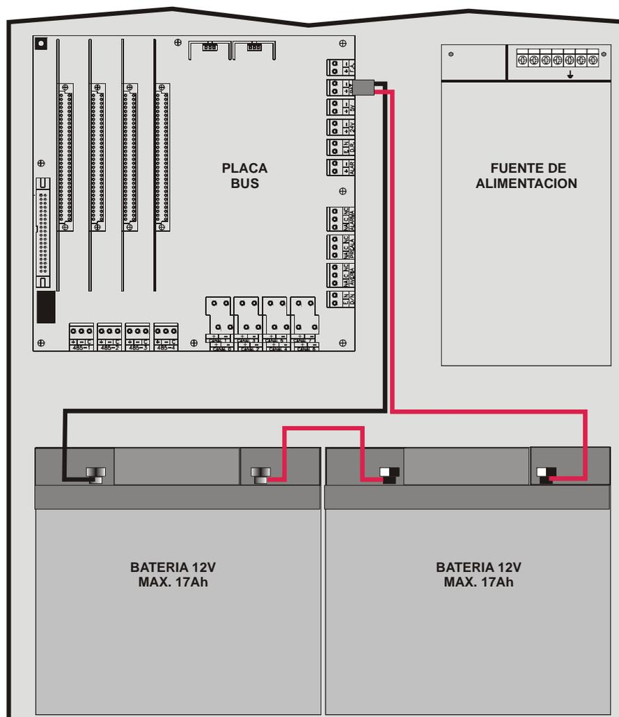
En la caja se incluye un cable de conexión para las baterías, conectado en la placa base. El conector rojo (positivo) debe conectarse al terminal positivo de la batería 1, y el conector negro (negativo) al terminal negativo de la batería 2.
