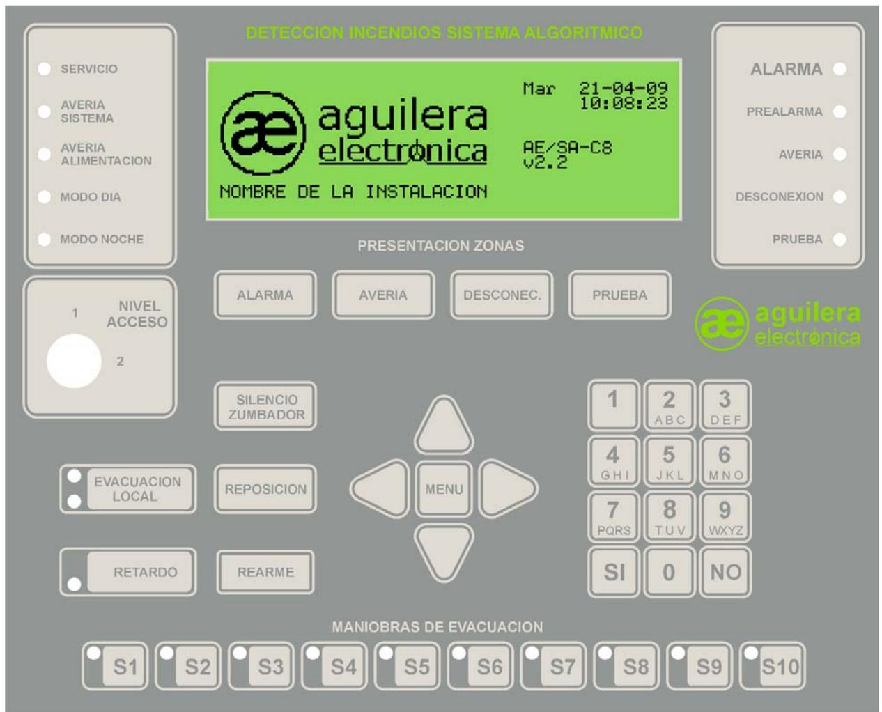
Mientras que el Panel no sea personalizado con los datos de la instalación, mostrará este mensaje en pantalla, indicando fecha y hora, modelo de panel y versión de software y configuración de los puertos serie.
