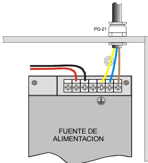
La alimentación de los equipos de control de incendios deberá disponer de un diferencial de protección independiente con un fusible de protección de 230Vca / 5A o superior. La sección de cableado de alimentación no será inferior a 0,75 mm<sup>2</sup>.
