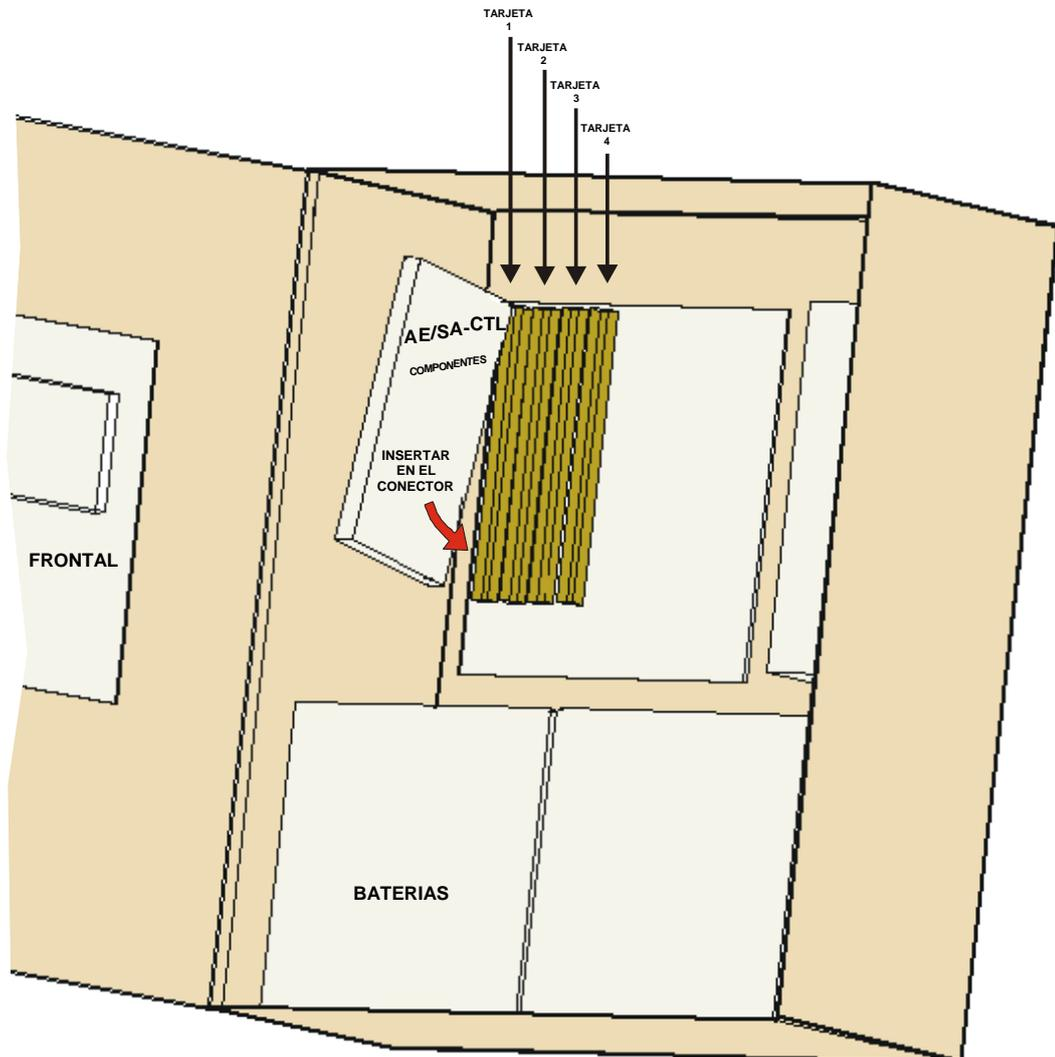
**i** Antes de realizar ninguna conexión, asegúrese de que la central está desconectada: interruptor SW1 en posición OFF.
