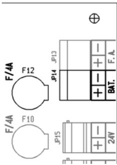
El cable de baterías debe permanecer desconectado de la placa base hasta terminar la conexión en ambas baterías, para evitar posibles cortocircuitos o derivaciones a tierra al hacer contacto con alguna parte metálica de la caja.
