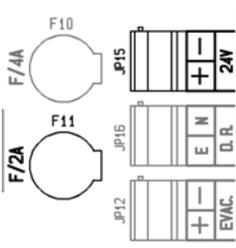
El equipo dispone de una salida auxiliar polarizada de 24V en el conector JP15.
