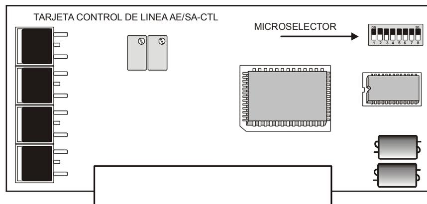
Cada una de las tarjetas debe tener un código diferente en el microselector, para ser identificada correctamente por la CPU. El número asignado en la tarjeta determinará el número de bucle en la instalación.
