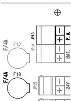
La alimentación de salida de la fuente de alimentación se aplica a la placa base a través del conector JP13, protegido mediante el fusible F10, para una corriente máxima de 4A.
