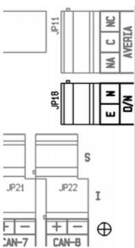
El Panel AE/SA-C8 permite que el modo de trabajo operativo se gestione remotamente mediante la clema JP18 habilitada a tal fin.
