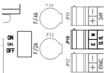
Para realizar la desconexión remota del equipo unir los terminales E y N.
