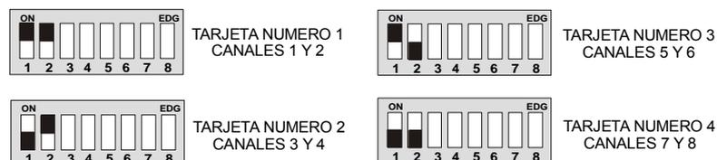
Una vez codificada la tarjeta es necesario conectarla en el bus según se indica en el esquema siguiente:
