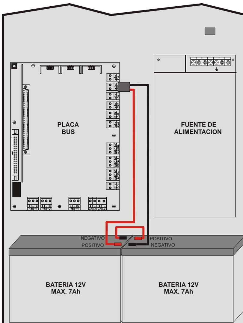
En la caja se incluye un cable de conexión para las baterías, conectado en la placa base. El conector rojo (positivo) debe conectarse al terminal positivo de la batería 1, y el conector negro (negativo) al terminal negativo de la batería 2.
