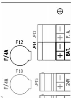
El cable de baterías debe permanecer desconectado de la placa base hasta terminar la conexión en ambas baterías, para evitar posibles cortocircuitos o derivaciones a tierra al hacer contacto con alguna parte metálica de la caja.
