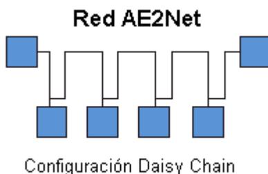
Las derivaciones y conexiones en estrella pueden provocar fallos de funcionamiento, en función de su longitud y la velocidad de funcionamiento de la red. Su uso está totalmente desaconsejado.
