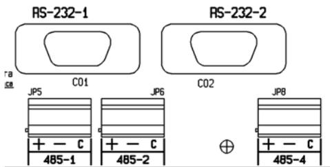
Los puertos COM1 y COM2 pueden configurarse como puertos RS-232 o RS-485, aunque obligatoriamente uno de ellos debe estar configurado como RS-232 a 9600 bps para permitir el volcado de la personalización. Normalmente este mismo puerto se utilizará simultáneamente para conectar una impresora, dejando el otro puerto libre para realizar integraciones de sistemas.
