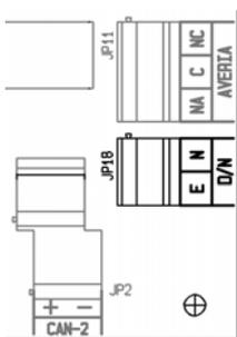
La Central AE/SA-C2 permite que el modo de trabajo operativo se gestione remotamente mediante la clema JP18 habilitada a tal fin.
