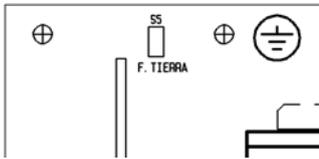
La supervisión de fallo de tierra debe estar habilitada durante el funcionamiento normal del sistema. La conexión de equipos en los puertos de comunicaciones RS-232 y RS-485 puede provocar la indicación de Fallo de Tierra, si dichos equipos tiene unificado el negativo de las comunicaciones con la Tierra de dicho equipo.
