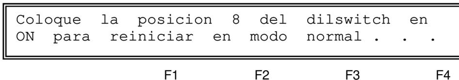
**NOTA:** En este caso NO es preciso apagar la central para cambiar la posición del selector.
