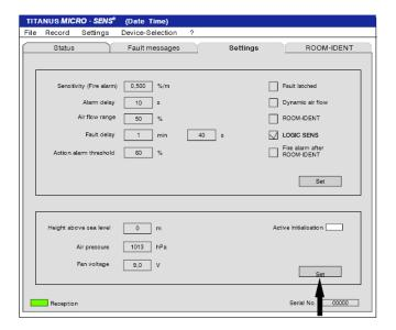
Determinar la altura sobre el nivel del mar donde se encuentra instalado el sistema de detección por aspiración TITANUS Micro-Sens, e introducir el valor.
