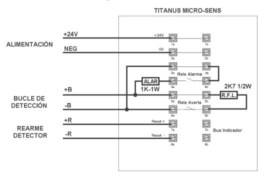
Este modelo incorpora salidas de alarma (Contacto abierto en reposo), y avería (contacto cerrado en reposo), que permiten la conexión a una zona convencional, o bucle de detección de un módulo máster, utilizando resistencias de carga de 1K y final de línea de 2K7.
