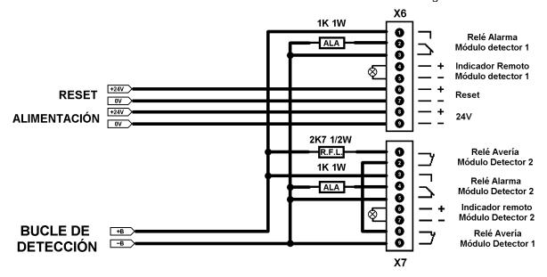
2.6.3 CONEXIÓN A BUCLE DE DETECCIÓN CONVENCIONAL CON MÓDULO DE REARME AET-RST.
