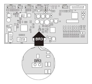
Una vez modificada la tensión de funcionamiento del ventilador, debe realizarse el proceso de ajuste del flujo de aire. La posición del selector BR3 solo debe cambiarse con el detector TITANUS Topo-Sens sin alimentación.
