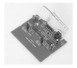
Antes de su conexión, en el interface deben configurarse los selectores SW1 y SW2 en función del equipo y número de módulos detectores instalados.
