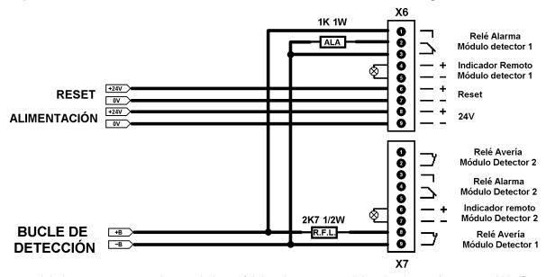
Este modelo incorpora para cada uno de los módulos detectores salidas de alarma (contactos NA, C y NC), y avería (contacto cerrado en reposo), que permiten la conexión a una zona convencional, o bucle de detección de un módulo máster, utilizando resistencias de carga de 1K y final de línea de 2K7.
