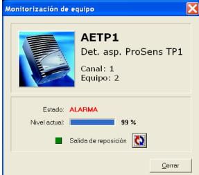
Si el detector se encuentra en estado de alarma, es posible hacer una reposición remota actuando sobre el botón de reposición, y volviéndolo a desactivar cuando pase a reposo.
