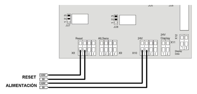
Si el detector TITANUS Top-Sens está conectado a una Central Algorítmica mediante el interface AE/SA-IT solo es necesario conectar la alimentación de 24V. El envío de información de estado y el raerme se realiza a través del interface.
