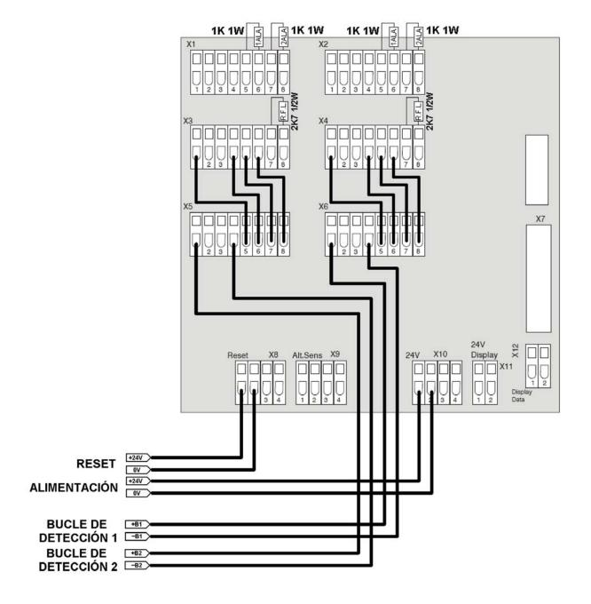
Este conexionado genera estados de 1ª Alarma con el relé de prealarma, y 2ª Alarma con el relé de alarma. Si solo se desea un nivel de alarma, hay que quitar la resistencia de 1K del relé de prealarma.
