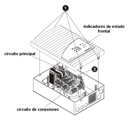
El circuito de conexiones incorpora clemas para los contactos de relés de los estados de prealarma, alarma y avería, así como para la colocación de las resistencias de final de línea y carga, facilitando el conexionado a diferentes sistemas de control.
