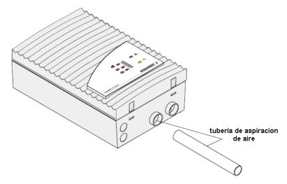
En ningún caso, debe utilizarse algún tipo de adhesivo para fijar el tubo al conducto de aspiración.
