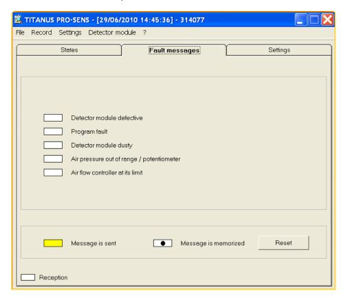
Fallo de funcionamiento del módulo detector. Debe sustituirse. Detector module defective
