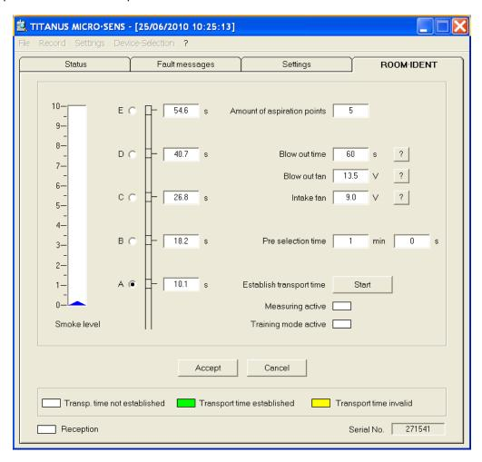
En primer lugar deben definirse el número de puntos de aspiración (Amount of aspiration points) de la instalación, estando limitados 5 como máximo, y el tiempo (Blow out time)y tensión de ventilador (Blow out fan) para realizar la limpieza de la tubería de aspiración.
