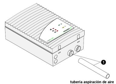
En ningún caso, debe utilizarse algún tipo de adhesivo para fijar el tubo al conducto de aspiración.
