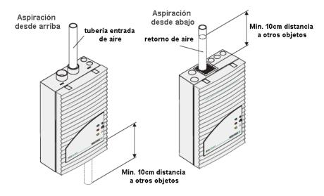
Para realizar un sistema de aspiración desde abajo, hay que girar la caja, y colocar la tapa de modo que los indicadores del frontal se lean correctamente.
