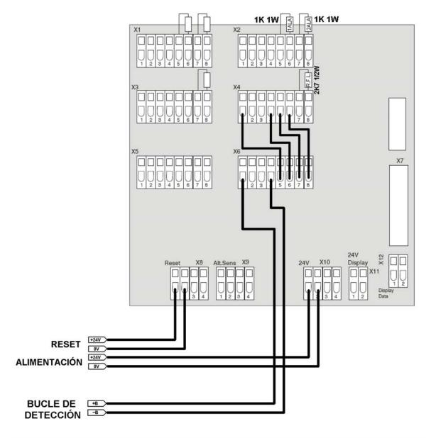
Este modelo incorpora para cada uno de los módulos detectores salidas de prealarma, alarma, y avería (contacto cerrado en reposo), que permiten la conexión a una zona convencional, o bucle de detección de un módulo máster, utilizando resistencias de carga de 1K y final de línea de 2K7.
