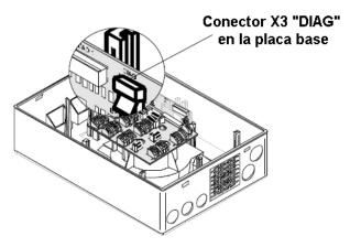
El interface se conecta al detector a través del conector de cinta plana de 6 vías, al conector de diagnóstico X3. Este conector es de tipo Micro-Match y va polarizado.
