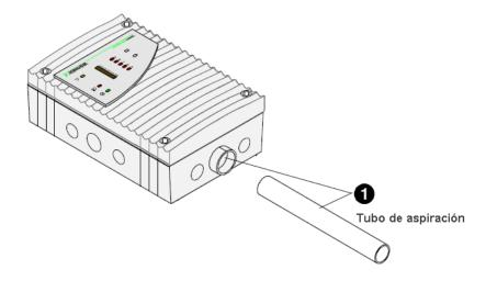
En ningún caso, debe utilizarse algún tipo de adhesivo para fijar el tubo al conducto de aspiración.
