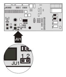
Una vez modificada la tensión de funcionamiento del ventilador, debe realizarse el proceso de ajuste del flujo de aire. La posición del selector JU1 solo debe cambiarse con el detector TITANUS Pro-Sens TP1 sin alimentación.
