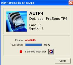
Si el detector se encuentra en estado de Alarma, es posible hacer una reposición remota actuando sobre el botón de Reposición, y volviéndolo a desactivar cuando pase a reposo.
