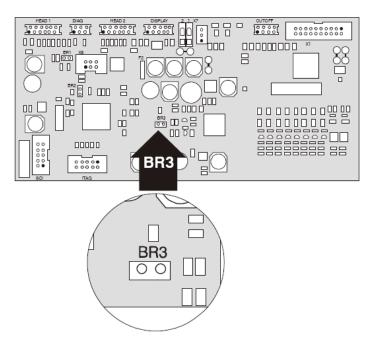
Una vez modificada la tensión de funcionamiento del ventilador, debe realizarse el proceso de ajuste del flujo de aire. La posición del selector BR3 solo debe cambiarse con los detectores TITANUS Pro-Sens TP4 o TP5 sin alimentación.
