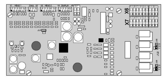
Para facilitar el conexionado, el circuito puede extraerse de los soportes donde se encuentra insertado.
