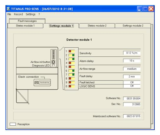
Sensitivity (Fire Alarm) Nivel de Alarma. Muestra el nivel de Alarma configurado en %/m de
