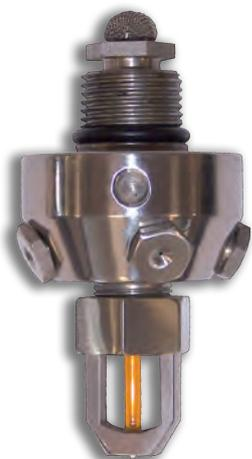
Fabriqués en acier inoxydable AISI 304, ils sont équipés d'une ampoule à fusible qui casse à une température prédéfinie et ouvre automatiquement le diffuseur. Ce diffuseur convient aux systèmes humides ou à préaction.
