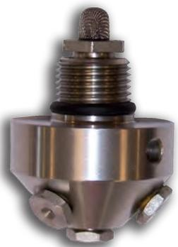
Fabriqués en acier inoxydable AISI 304. Ils sont installés dans des tuyaux secs, où il est nécessaire d'installer un système qui détecte l'incendie et contrôle le démarrage des pompes électriques ou le tir des bouteilles, selon que l'un ou l'autre système est installé.
